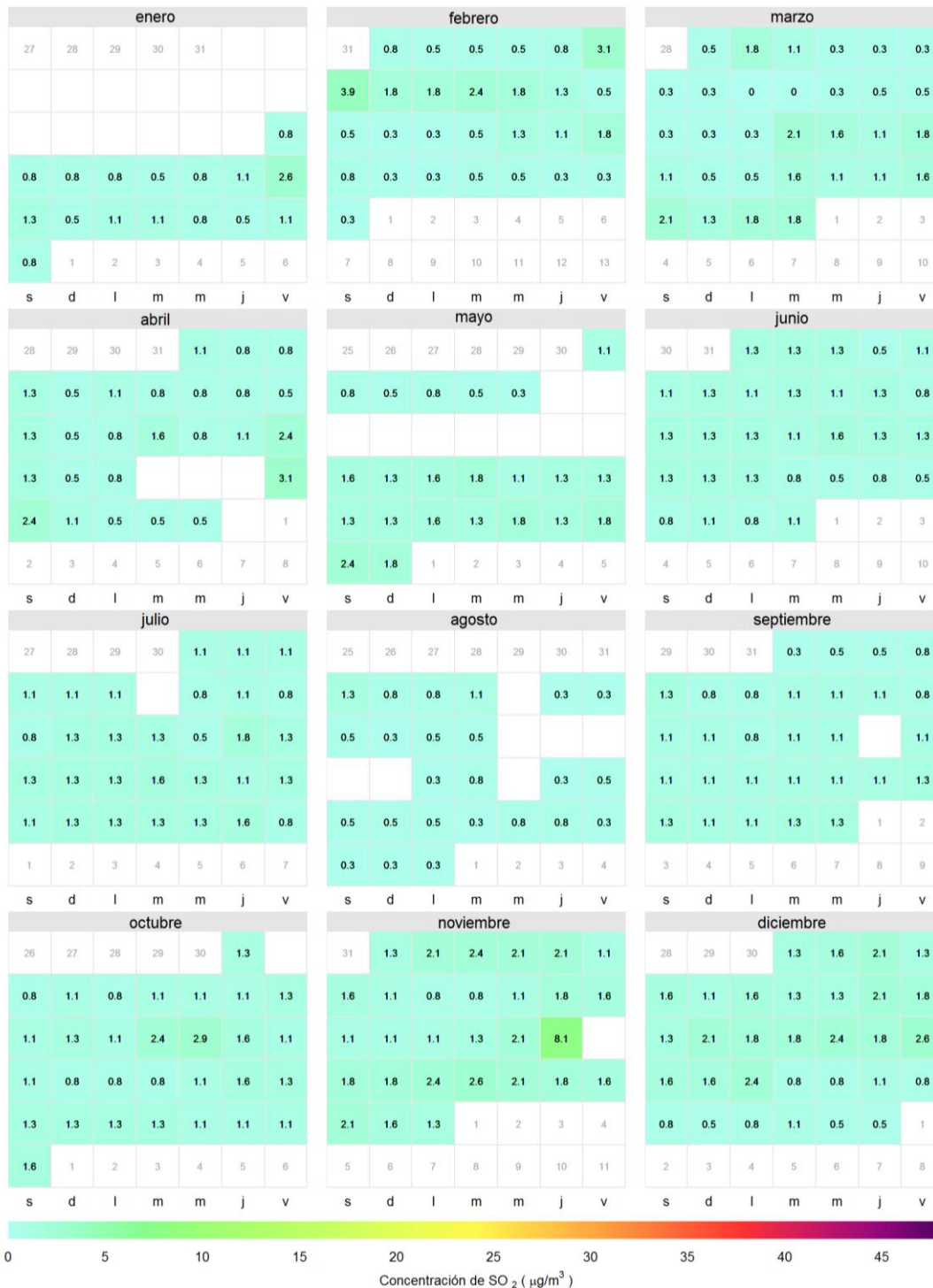
Figura 3-54. Calendario de concentración para SO 2 durante el año 2015 en la estación San Cristóbal. Los valores mostrados corresponden a la concentración. El límite máximo permisible es 250 µg/m 3 .
